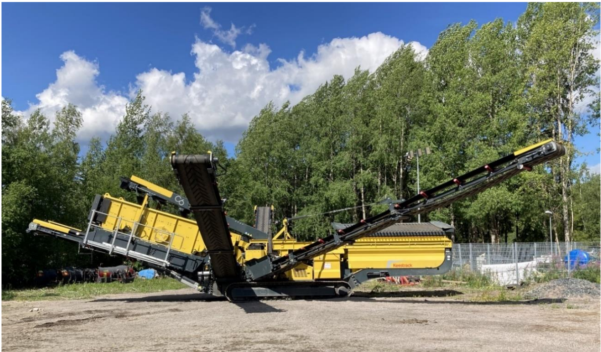
Kuva 5. Hiekoitussepeän puhdistusseulontaan käytetty 3-tasoseula.
