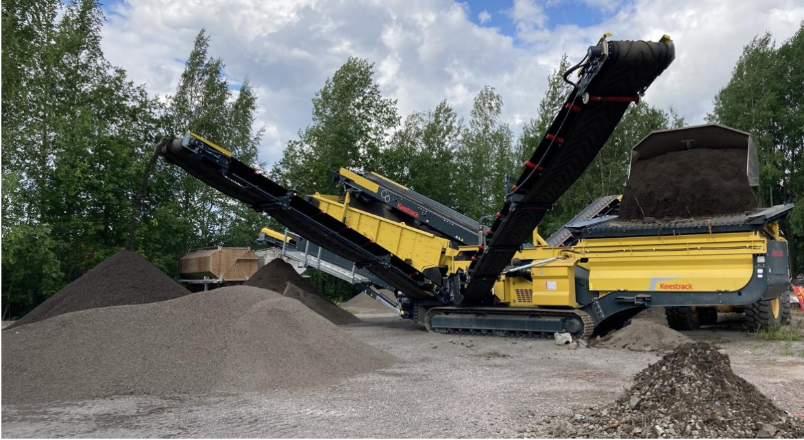
Kuva 6. Käytetyn hiekoitusseppelin seulontatyö käynnissä.
