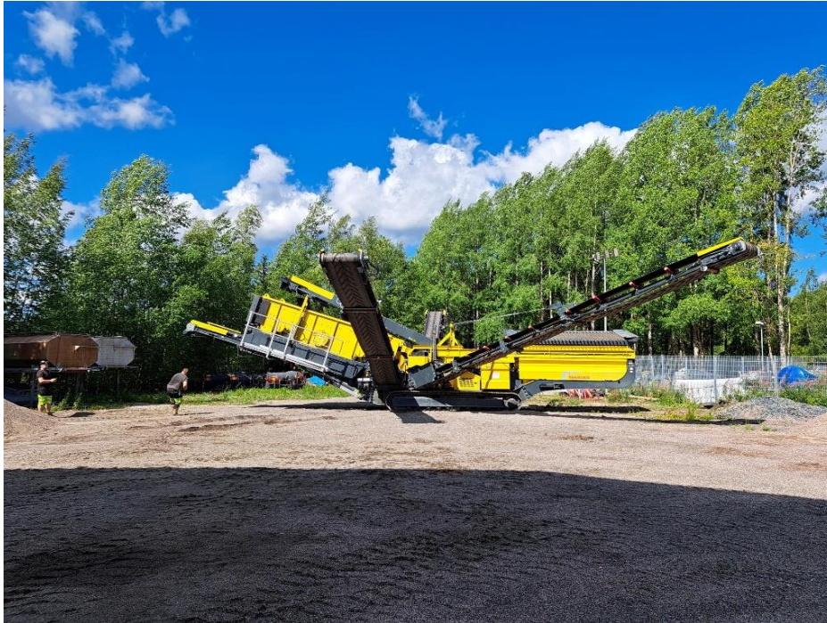
Kuva 8. Hiekoitushiekan puhdistukseen käytetty Keestrack C6 niminen seula
